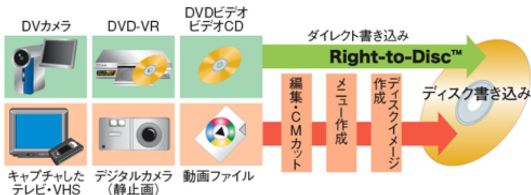
Right-to-Disc はキャプチャデバイスから直接ディスクに書き込む技術です。Disk から Disk のコピーには ディスクコピー機能をご利用いただけます。
